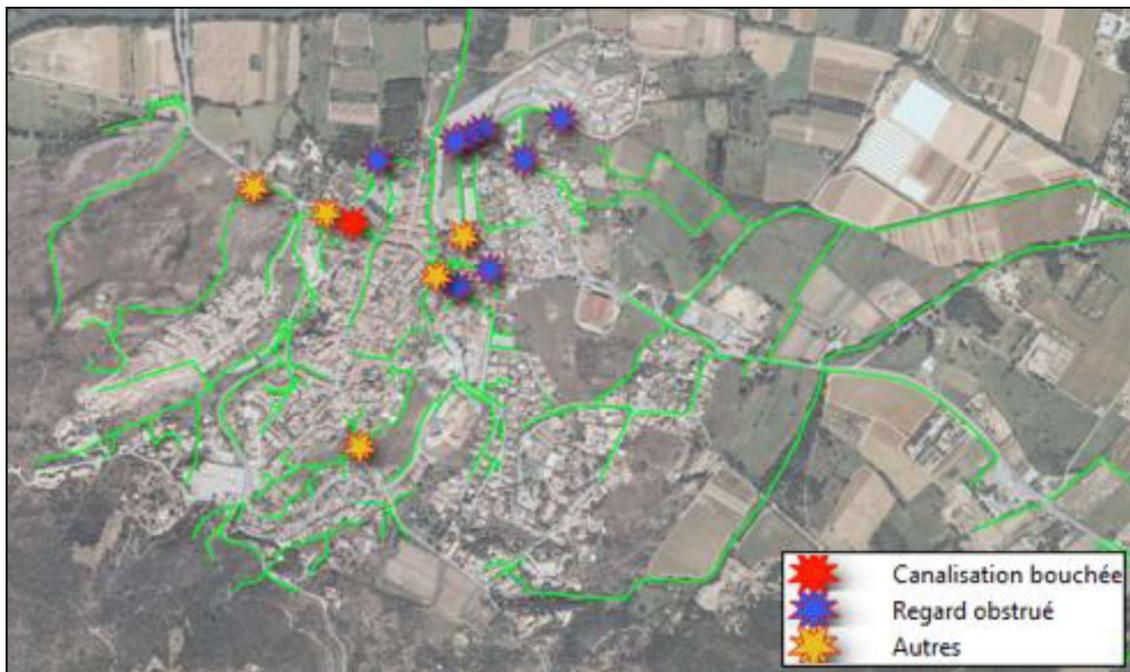
Figure 4-11 : Commune de Roquebrune-sur-Argens-les-Bains défauts constatés sur le secteur le village (Source : [Artelia, 2016] – Traitement Hydratec)
